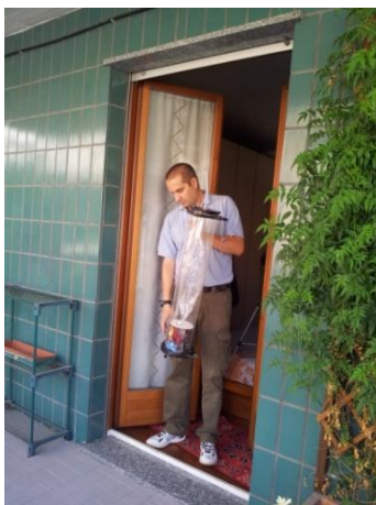
Figura 2 – Prelievo del campione gassoso presso l'abitazione del disturbato, mediante l'apposita sacca ( bag ) di 8 litri.
